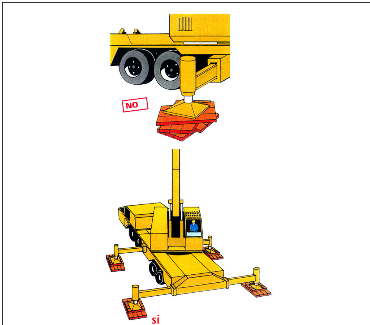
Col·locació estabilitzadors recolçaments
