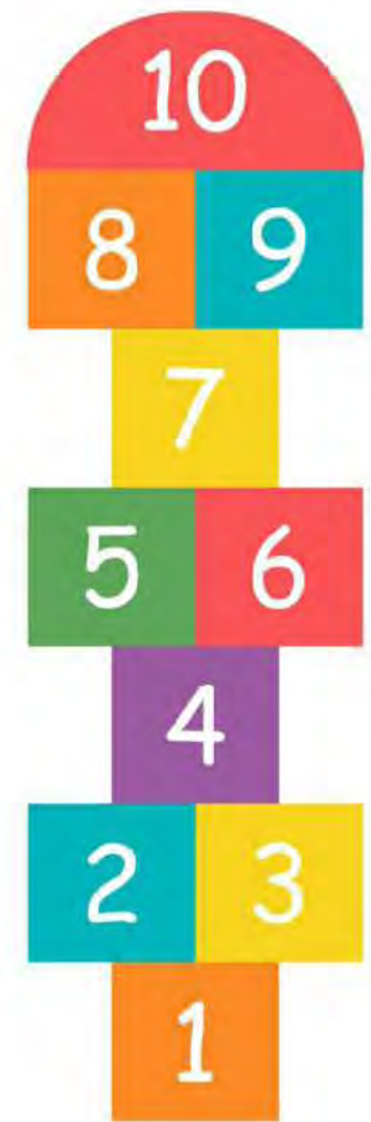
J4 Joc de la xarranca pintat amb esmalt de poliuretà sobre superfície de formigó existent. Dimensions 320x80 cm.
