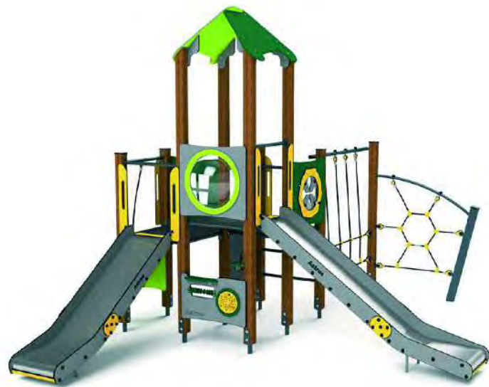
J3 Multijoc amb dos accessos, dos tobogans de polietilè, un torreó amb coberta, joc de cordes i jocs interactius a la part inferior, amb estructura de fusta laminada i tractada i elements decoratius amb HDPE de colors. Dimensions en planta de 465x390 cm, model "10022" de la casa Astrus Playgrounds o equivalent.
