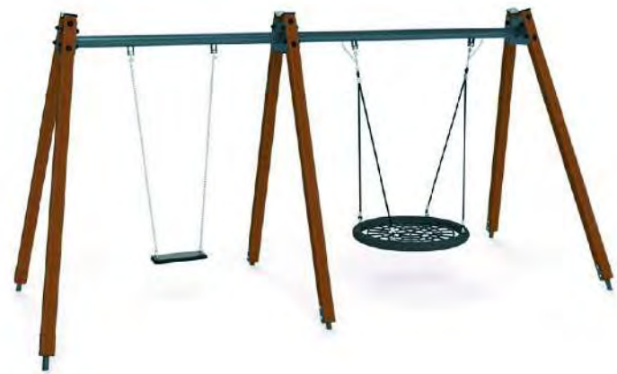
J2 Gronxador amb 1 seient pla amb recobriments exterior de goma i 1 seient niu (adaptat) amb cordes amb ànima d'acer, amb estructura de fusta laminada i tractada. Dimensions en planta de 235x455 cm, model "3510D" de la casa Astrus Playgrounds o equivalent.
