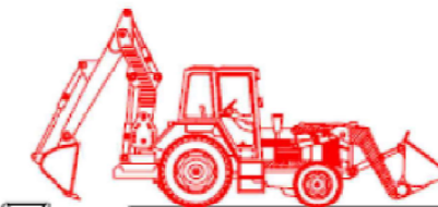
6. Reblert del pou amb retro-excavadora en tongades
